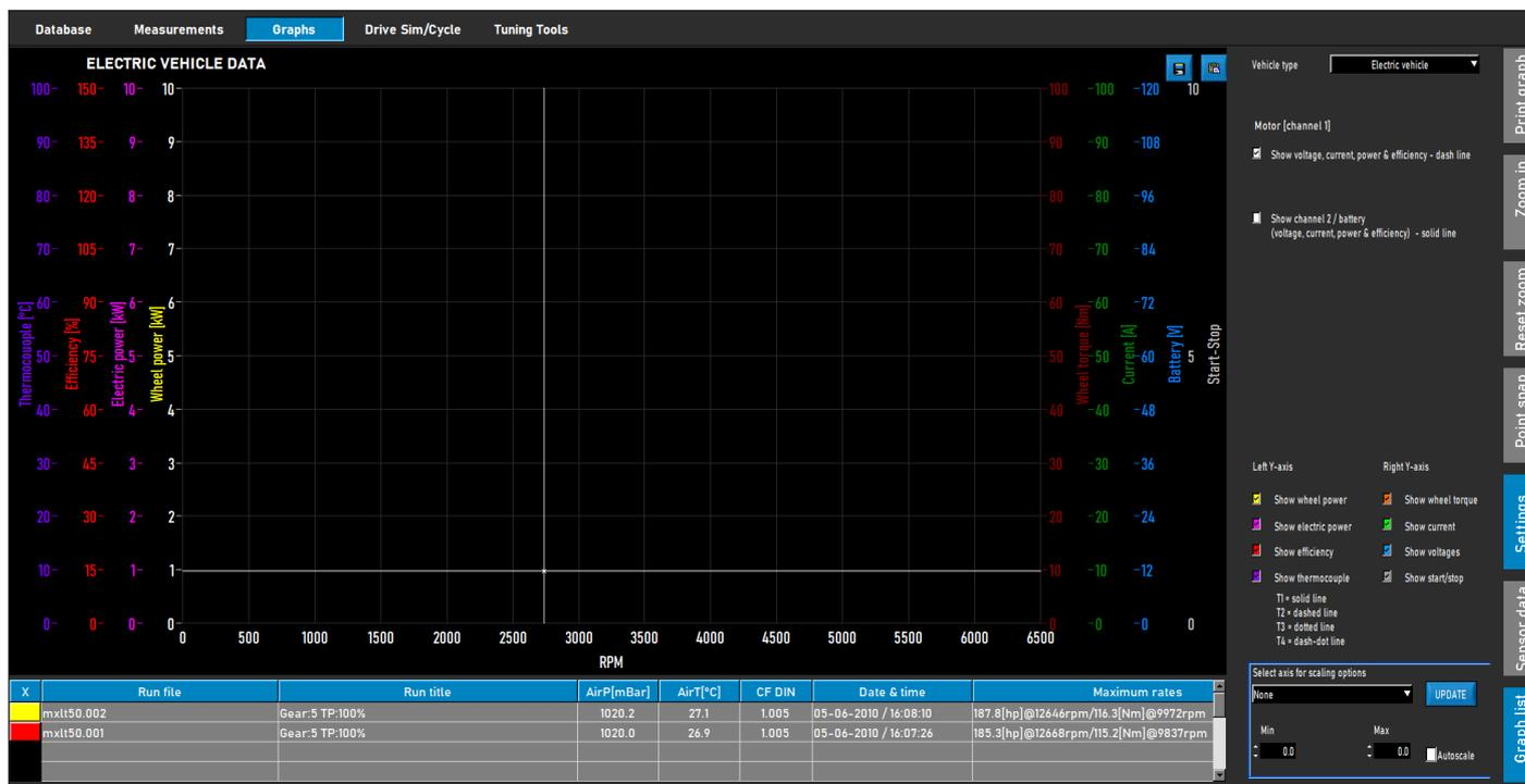
**GRAFIKEINSTELLUNGEN, Korrekturfaktor;** wählen Sie den gewünschten Korrekturfaktor (DIN, SAE oder EEC/EWG). Wetterstationsdaten werden immer aufgezeichnet, Änderungen vor oder nach der Messung sind daher jederzeit möglich. Für einen korrekten Datenvergleich wird empfohlen, immer einen Korrekturfaktor zu verwenden.
